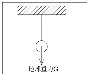
承重支架以抵抗重力为目标将管线固定在建筑物上的支吊架系统。
